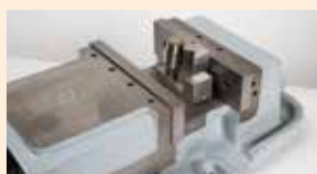
アングルブロックで角度加工
